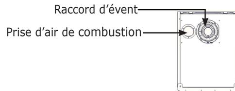
**Vue de dessous Identification des raccordements**
