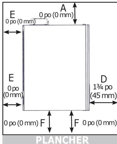
**FIGURE 4-2a Dégagement pour l'entretien, avant de la chaudière**
