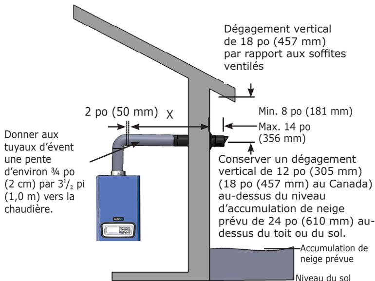
**FIGURE 6-3 Événement coaxial pour installation sur le toit**
