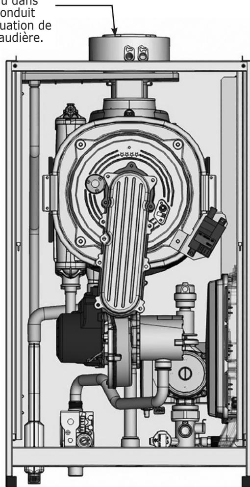
Tuyau d'écoulement de la condensation
