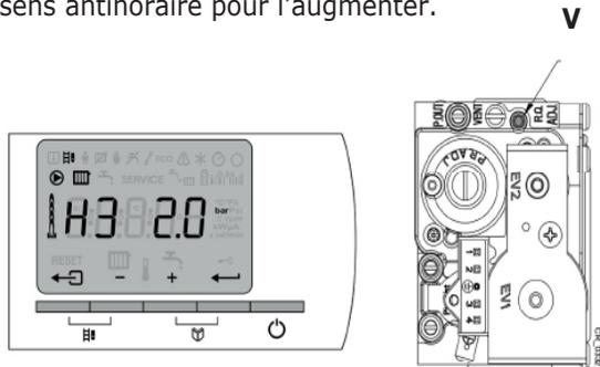
9.11 Réglage de la combustion (puissance minimale)
