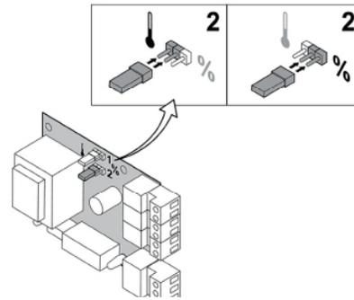
**FIGURE 8-8 Sortie analogique 0 à 10 V**
