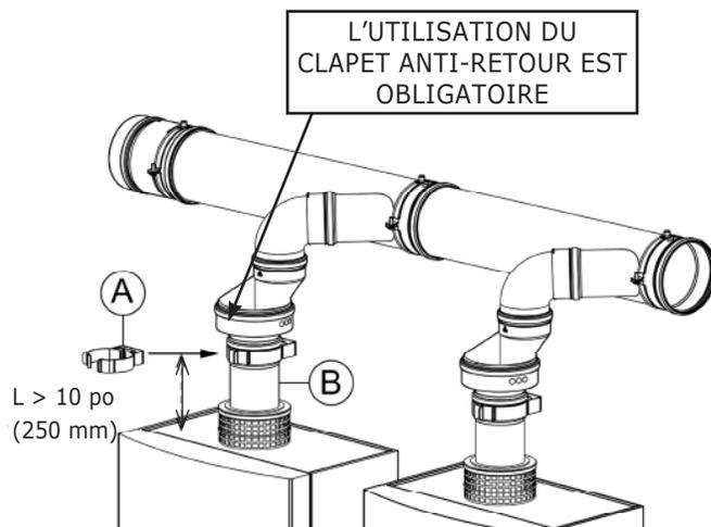
**FIGURE 6-22 Installation adéquate des canalisations**
