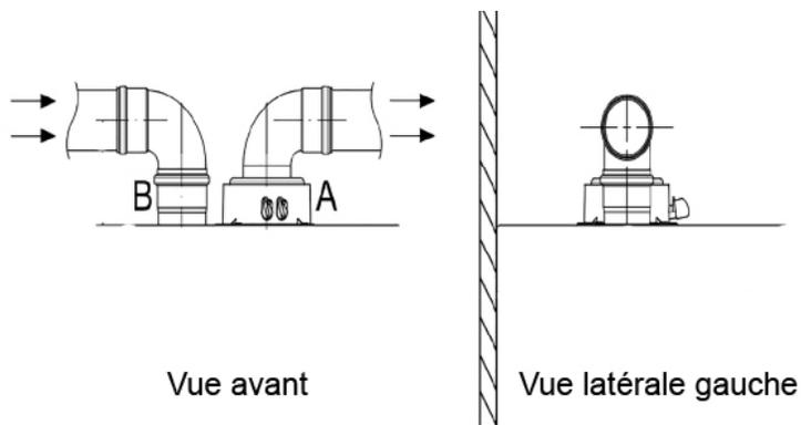
**FIGURE 6-6 Options d’installation d’extrémités d’évent horizontales séparées**
