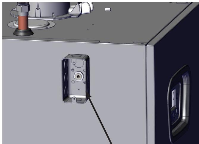
Boîte de jonction avec Knockouts et œilletons
