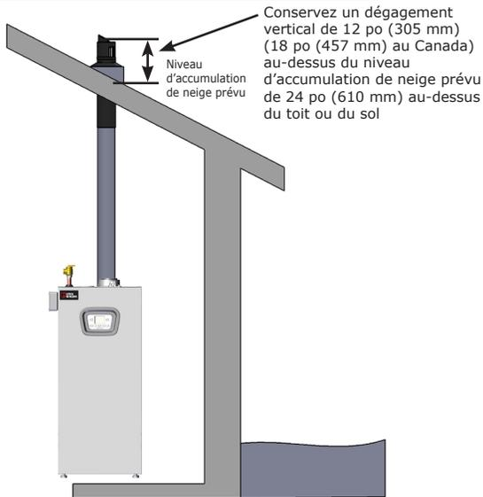
**FIGURE 5-5 – Échappement vertical coaxial - Plusieurs appareils PEUT ÊTRE UTILISÉE SUR TOUTES LES TAILLES**
