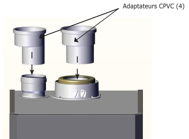
**Figure 5-19 – Adaptateur de tuyau double en CPVC pour les modèles de chaudières 165 à 205**
