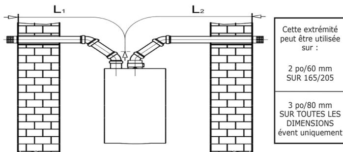
**FIGURE 5-9 – Tuyau double avec extrémités d’évent horizontales séparées de 2 po/60 mm et 3 po/80 mm**
