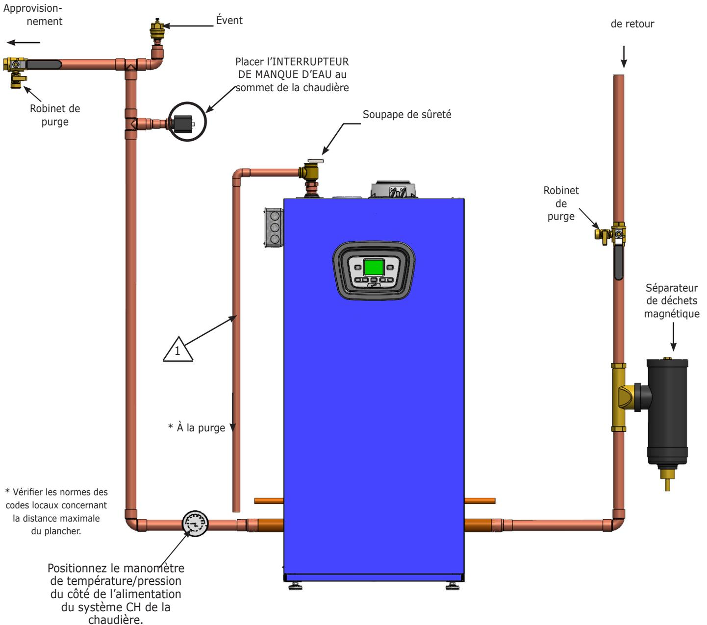
**Note** 1 NE PLACEZ PAS LA VANNE AVANT l'INTERRUPTEUR DE MANQUE D'EAU
