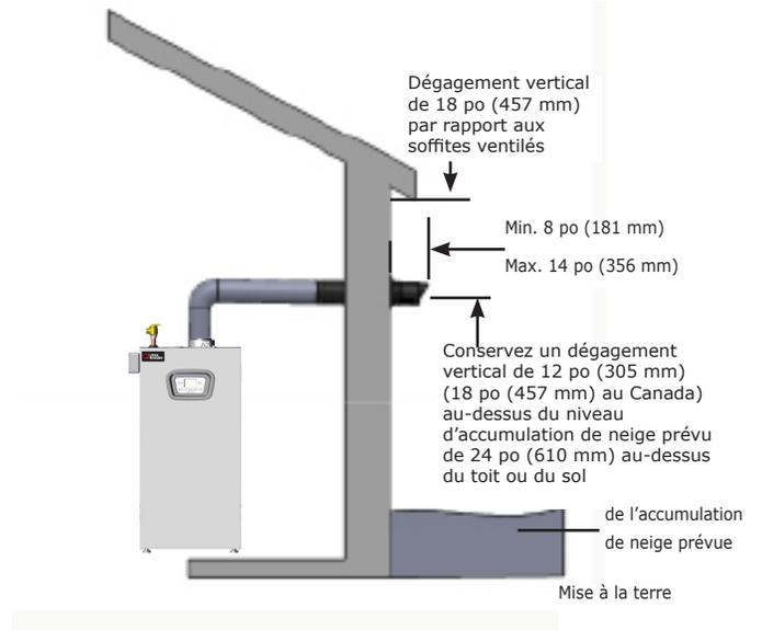
**FIGURE 5-7 – Échappement horizontal coaxial - Plusieurs appareils PEUT ÊTRE UTILISÉE SUR TOUTES LES TAILLES**
