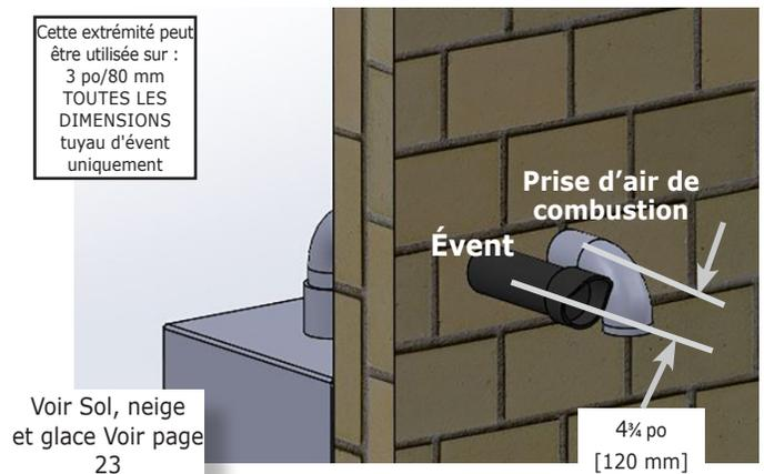
**FIGURE 5-25 – Tuyau double horizontal, évacuation et prise d’air**
